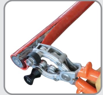
Extracción de la cubierta protectora
