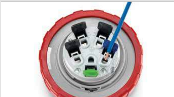
Clavijas y prolongadores de 32A con borne por resorte sin tornillos. Se debe pelar el cable, pero no apretar tornillos.
